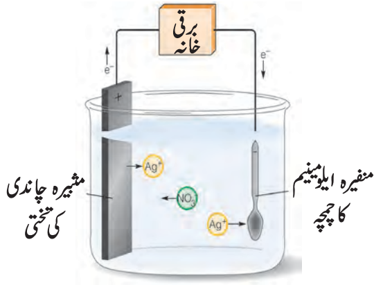
8.17: برقی ملح کاری
